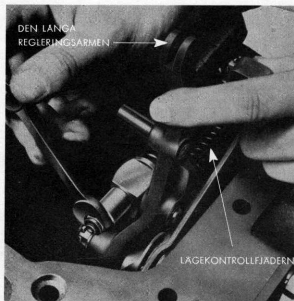
Fig. 35. Fastsättning av tärningen på dragkontrollstängan.
