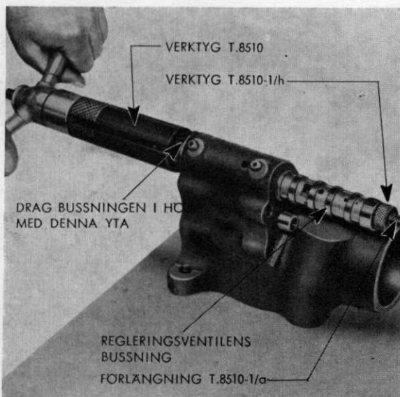
Fig. 26. Montering av regleringsventilens bussning.
