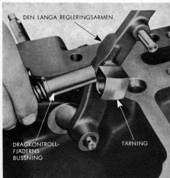
Fig. 30. Demontering av den långa regleringsarmen.
