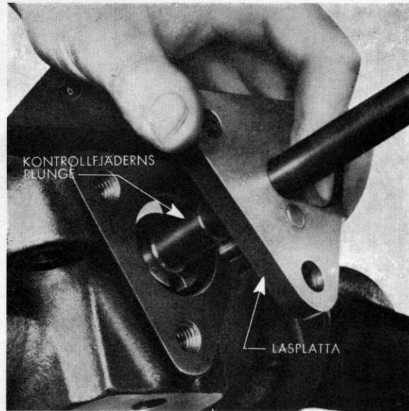
Fig. 37. Montering av kontrollfjädersnens låsplatta.
