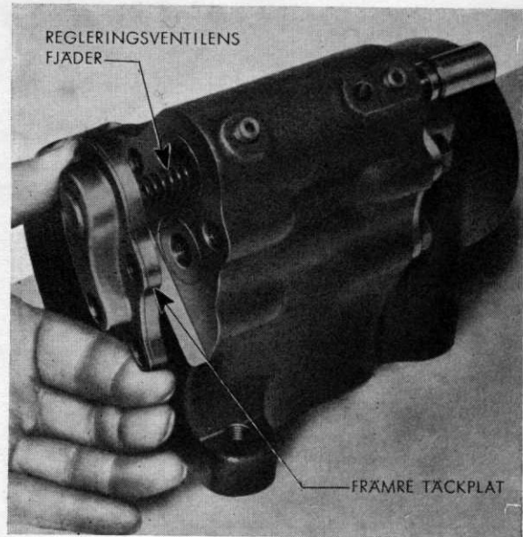
Fig. 27. Montering av arbetscilinderns främre täckplåt.
